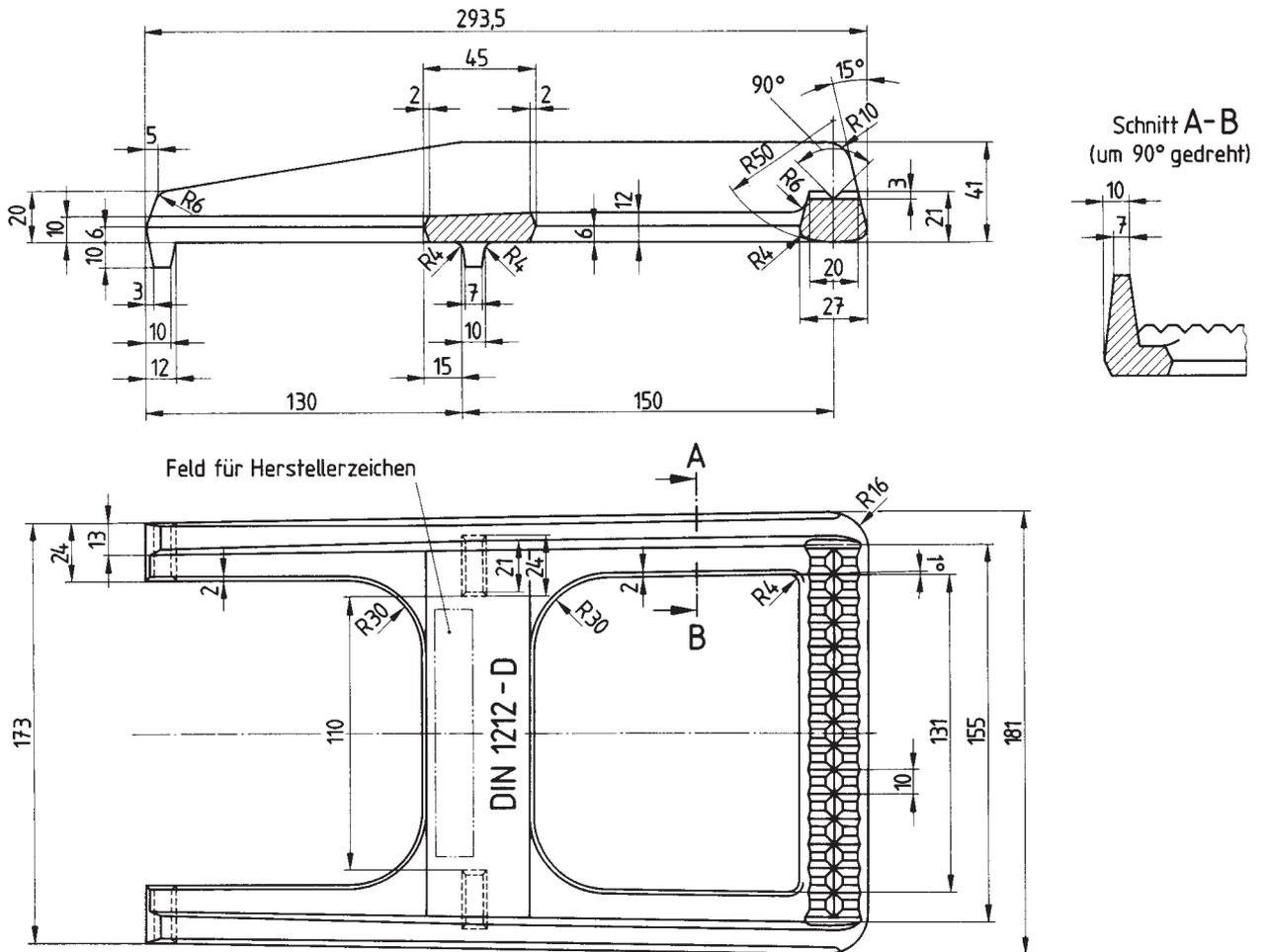
Bezeichnung eines Steigeisens mit Aufkantung für zweiläufige Steigeisengänge zum Einmauern oder Einbetonieren (D):
